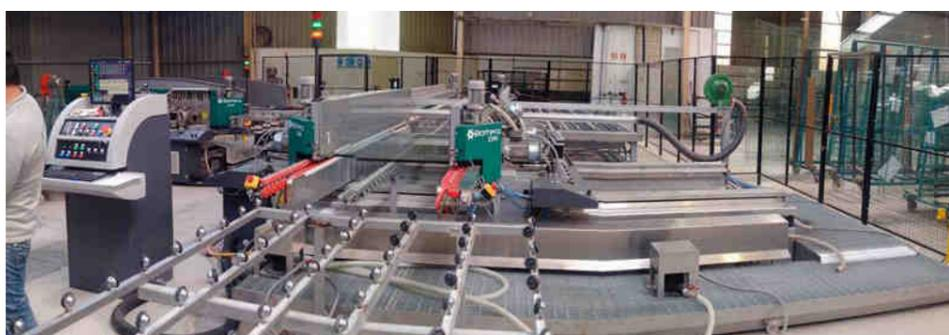
Quadrilateral TITAN com a possibilidade de qualidade de aresta e exatidão nas esquinas em todo o vidro incluindo o Low-e. Com sistema automático mediante leitor de código de barras para fecho, abertura e ajuste de espessura em automático;
