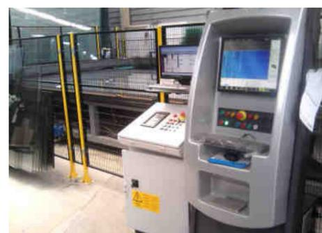
Máquina de corte 343 EVO-J para vidro 6.000 x 3.355, com seleção automática para precisão de corte, controlo completo sobre o rastreamento do vidro permitindo automatização de processos em toda a fábrica, desde corte, arestas, duplo e têmpera. É a primeira máquina de corte, desbordagem e impressão de etiquetas em Portugal!
